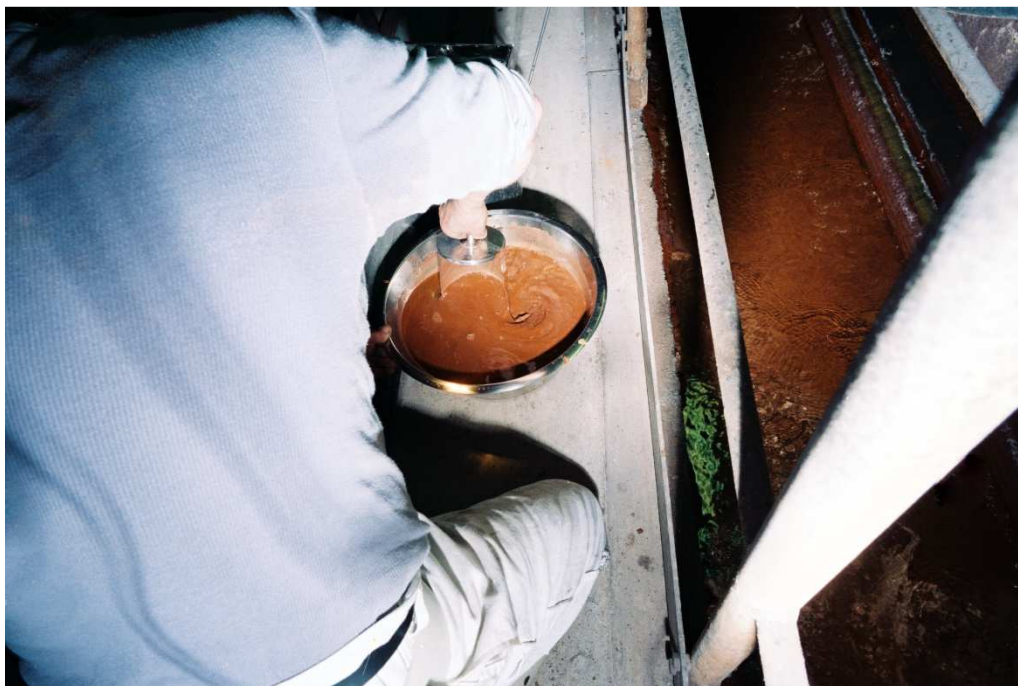
Abb. 20: Homogenisierung einer Schlammprobe aus einem Absetzbecken (rechts im Bild, Punkt 10 in Abb. 23) auf AV (Quelle: RAG)
